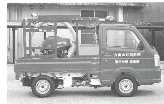
▲引渡された小型動力ポンプ付消防積載車
